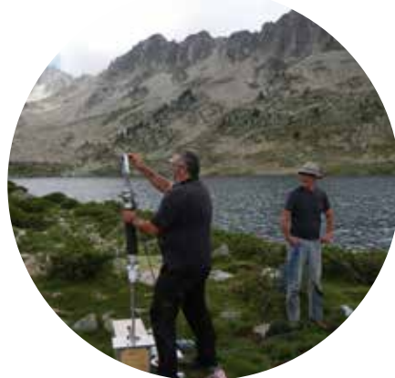
Etude palynologique par carottages de sédiments lacustres, avec le laboratoire GEODE, lac de Port Bielh, vallée d'Aure
