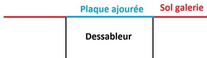
Le dispositif devra disposer d'une chasse permettant d'évacuer automatiquement les sables, et d'un dispositif de vanne en sortie (*entre le dessableur et la cuve*) permettant de fermer l'arrivée d'eau dans la cuve en aval. Cette vanne sera équipée d'un by-pass permettant de chasser le sable éventuel accumulé entre le dessableur et la cuve. Elle sera logée dans un regard visitable.
