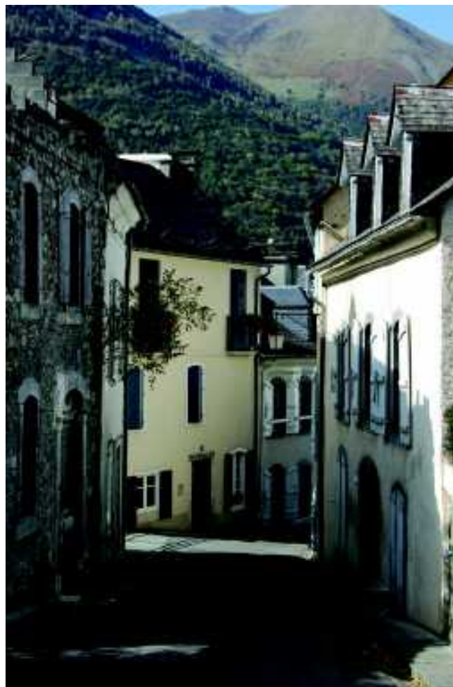
La densité du bâti et un gabarit étroit des rues protègent des vents et du froid.
